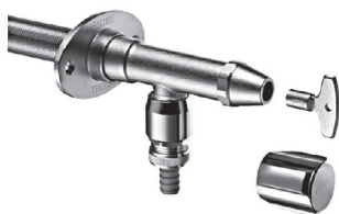
venkovní mrazuvzdorný ventil POLAR II Set 1/2" s instalační konstrukční sadou pro tloušťku zdiva 200-500 mm
